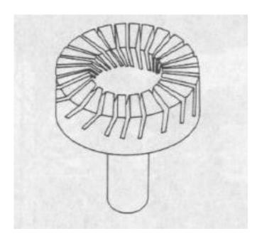
Reece于1961年加入英国联合电气工业公司,在那期间发明了杯状横磁触头,使得处于集聚态的电弧 把热分散在整个触头上,减少了金属蒸气的产生。
